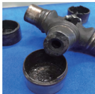
破損したジャーナル（継ぎ手）
